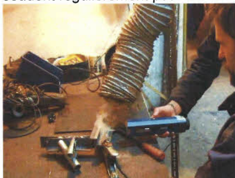
Figure 9. Atelier aspiration des fumées de soudage
