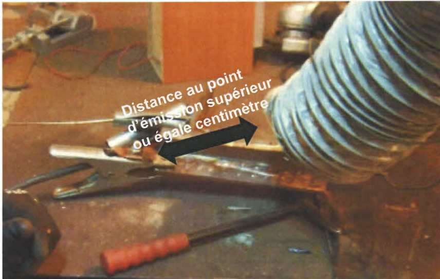
Figure 12. Aspiration placée approximativement de 15 centimètres du point d'émission.
